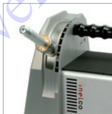
Schleifen der Elektrode im gewünschten Winkel.
