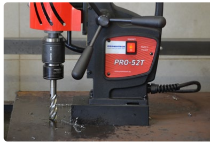
Gewindeschneiden von Sacklöchern bis M20
