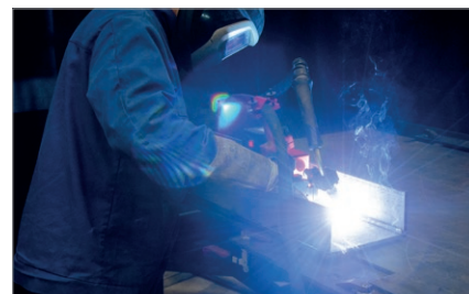
Schweißen in engen Räumen (min. Breite 200 mm)
